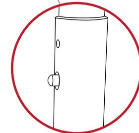
Étendre le mât jusqu'à ce que chaque mécanisme s'enclenche
