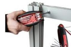
» A l'aide d'une clé "Allen" 5 mm, verrouiller l'ensemble
