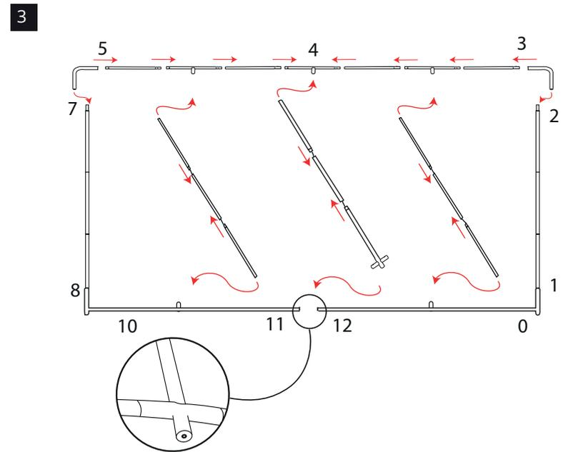
**Montage du visuel et fixation des pieds structure 6m**
